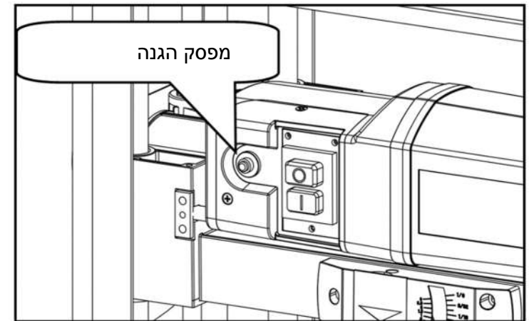
שימו לב: קיים רכיב הגנה מפני זרם עודף בתוך המעגל החשמלי.
